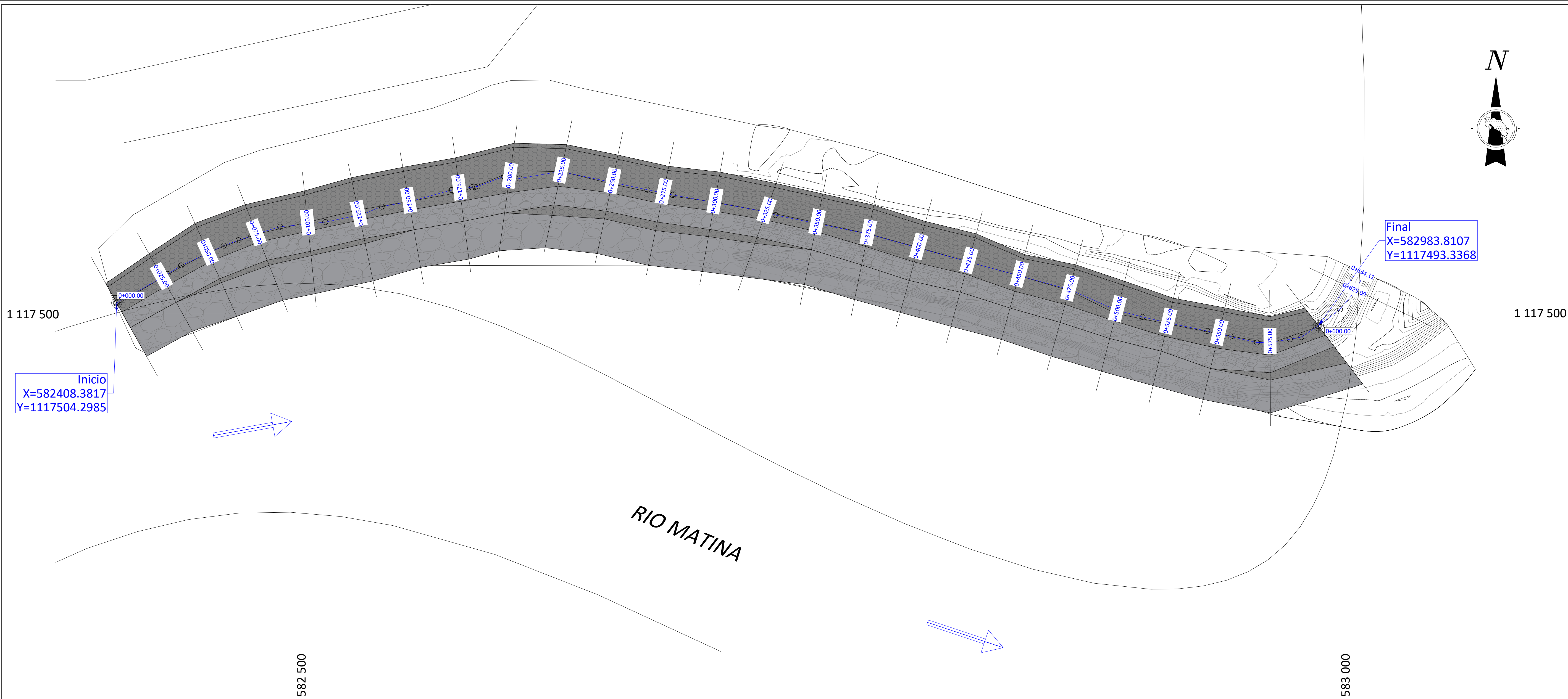
VISTA EN PLANTA PROTECCIÓN ZONA K ESCALA 1:1000
