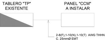
NOTA: EL TIPO DE TUBERÍA DEPENDERÁ DEL LUGAR A INSTALAR.
