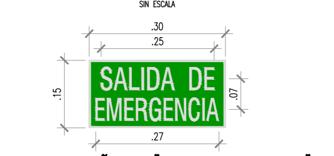
DETALLE DE SEÑAL DE "SALIDA DE EMERGENCIA"
