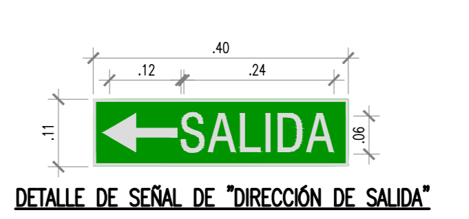
DETALLE DE SEÑAL DE "DIRECCIÓN DE SALIDA"
