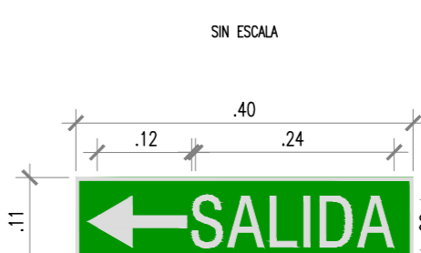
DETALLE DE SEÑAL DE "DIRECCIÓN DE SALIDA" SIN ESCALA
