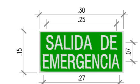
DETALLE DE SEÑAL DE "SALIDA DE EMERGENCIA" SIN ESCALA
