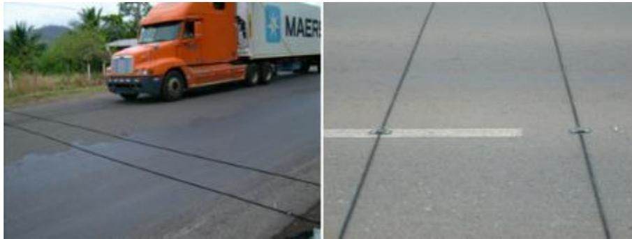
Figura 102.2. Ejemplo de contador de mangueras en sitio.
