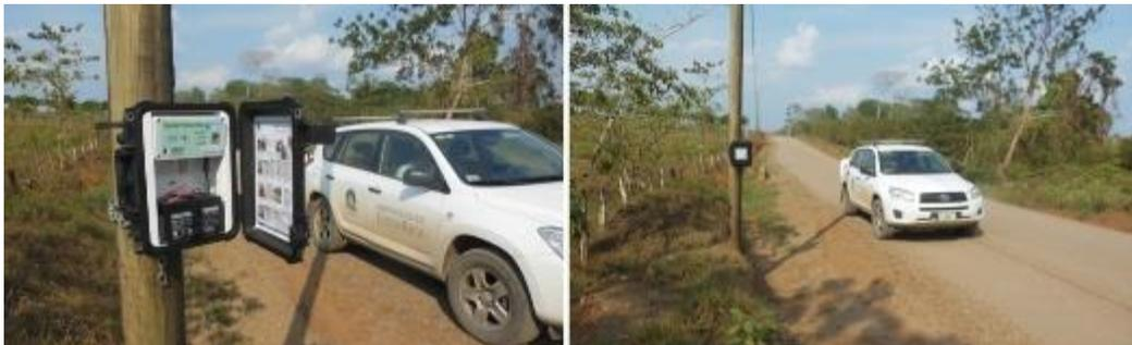
Figura 102-1. Ejemplo de contador de radar en sitio.
