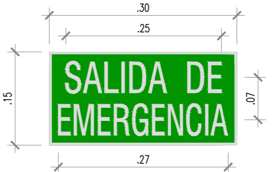
DETALLE DE SEÑAL DE DIRECCION DE SALIDA DE EMERGENCIA SIN ESCALA
