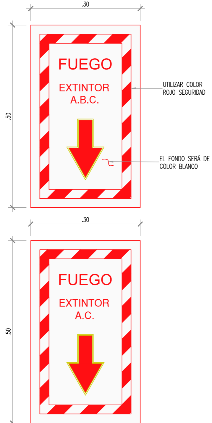
DETALLE DE LETRERO PARA EXTINTOR SIN ESCALA
