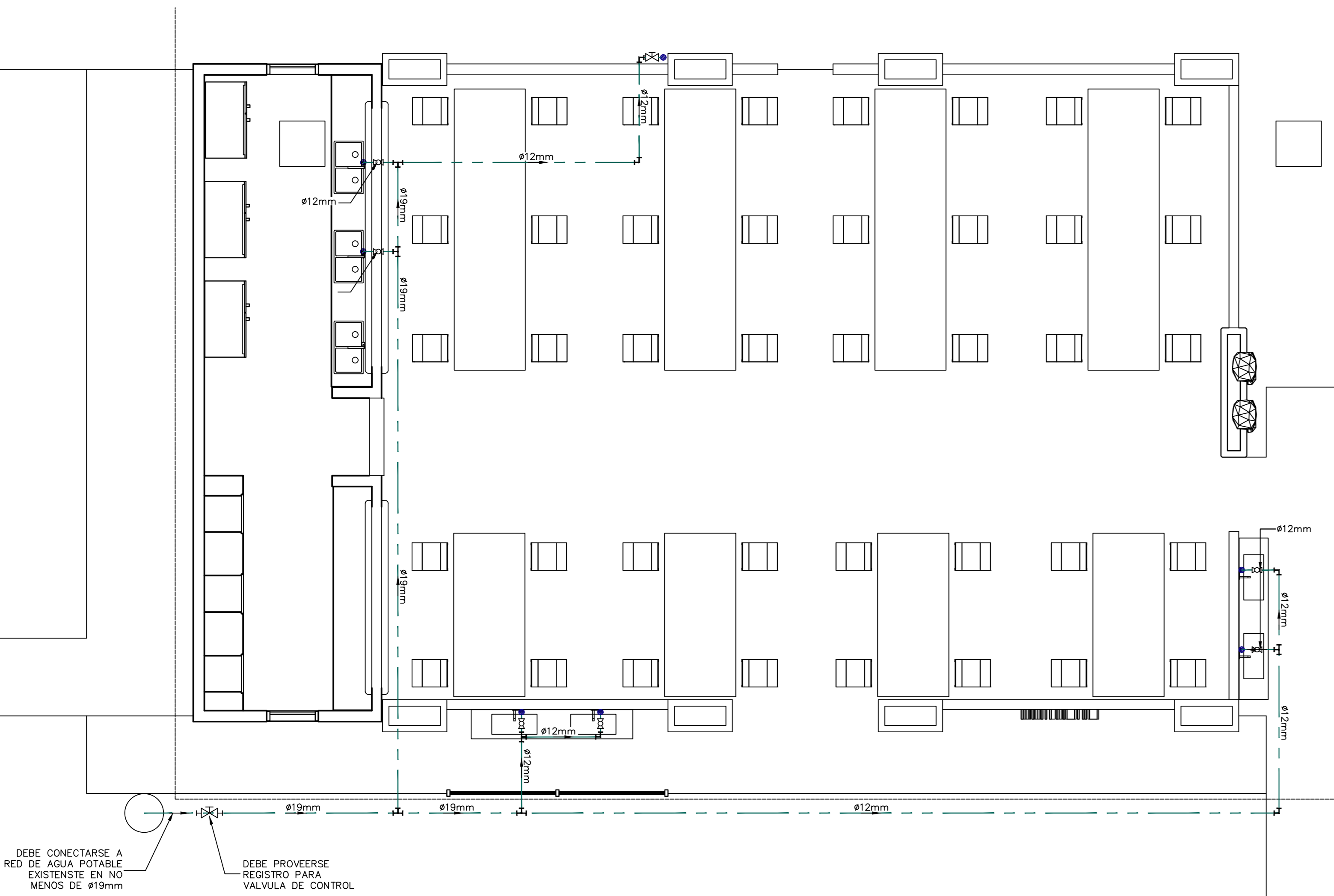
PLANTA DE AGUA POTABLE ESCALA 1:50
