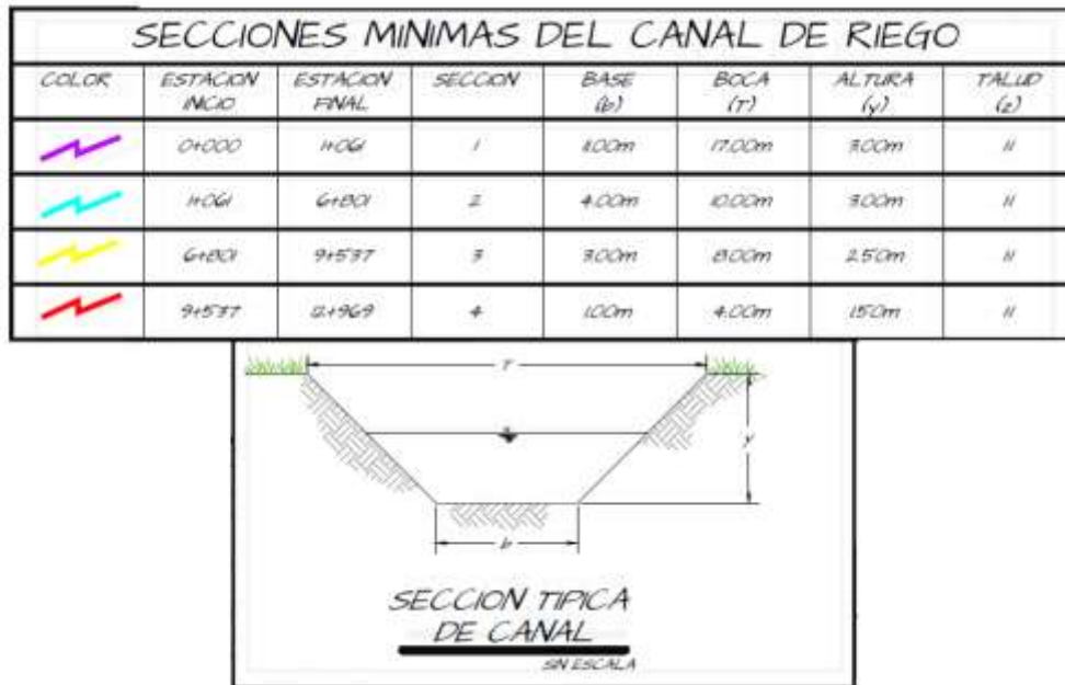
Figura 2. Detalle de secciones transversales para canal de riego. SENARA, 2021
